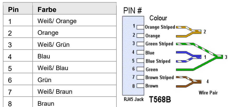
Abb. 15: Belegung Anschluss Ethernet, EIA/TIA-T568B
