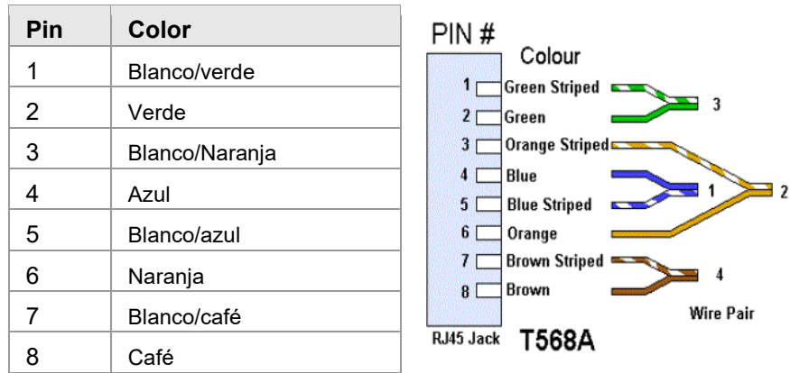
Fig. 14: Configuración conexión Ethernet, EIA/TIA-T568A
