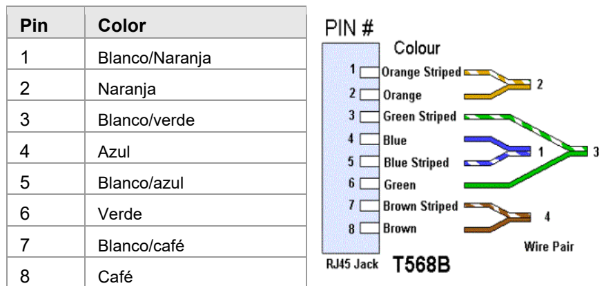
Fig. 15: Configuración conexión Ethernet, EIA/TIA-T568B
