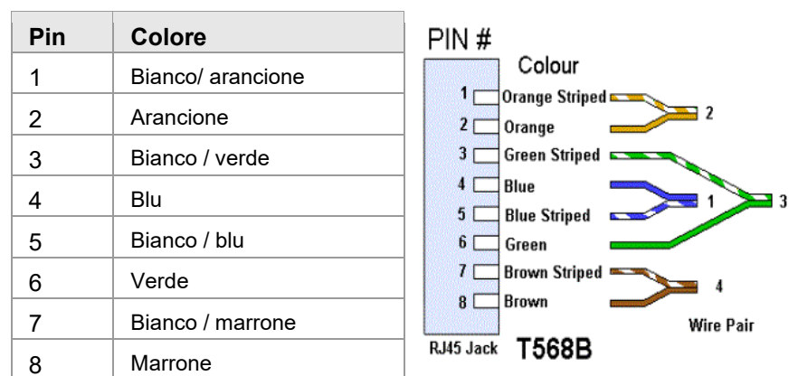
Fig. 15: Assegnazione secondo lo standard EIA/TIA-T568B
