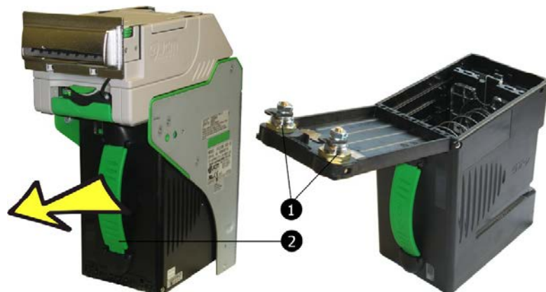
Abb. 82: Kassette entnehmen und öffnen (Abbildung mit Optionen)
