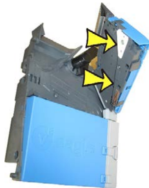
Abb. 80: Unterkante des Münzweges reinigen
