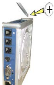
Abb. 44: Batteriewechsel am LCC
