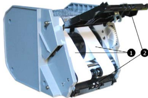
Abb. 97: Recycling- oder (Multi-)Escrow-Kassette reinigen
