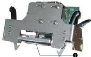
Fig. 52: Thermal printer
