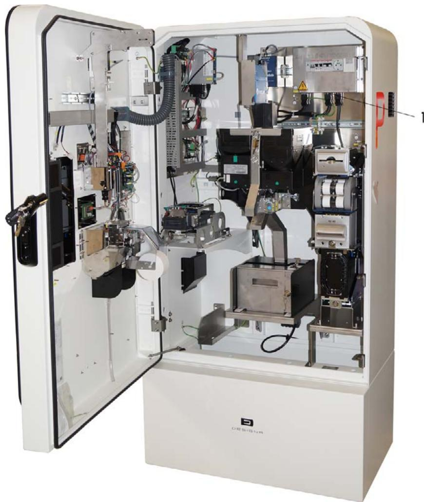
Fig. 39: Punto de medición para la revisión de la impedancia del bucle de falla
