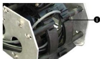
Fig. 49: Ranura de alimentación MPS
