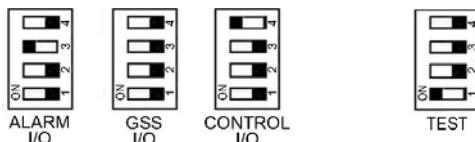
Fig. 45: Posiciones del interruptor DIP
