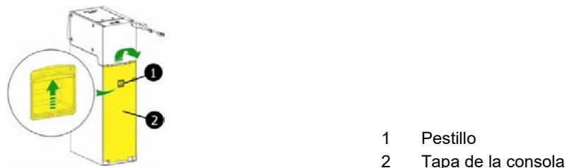
Fig. 110: Abrir la tapa de la consola
