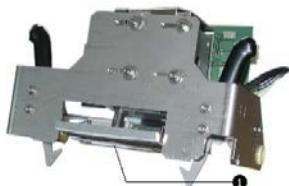
Fig. 52: Impresora térmica
