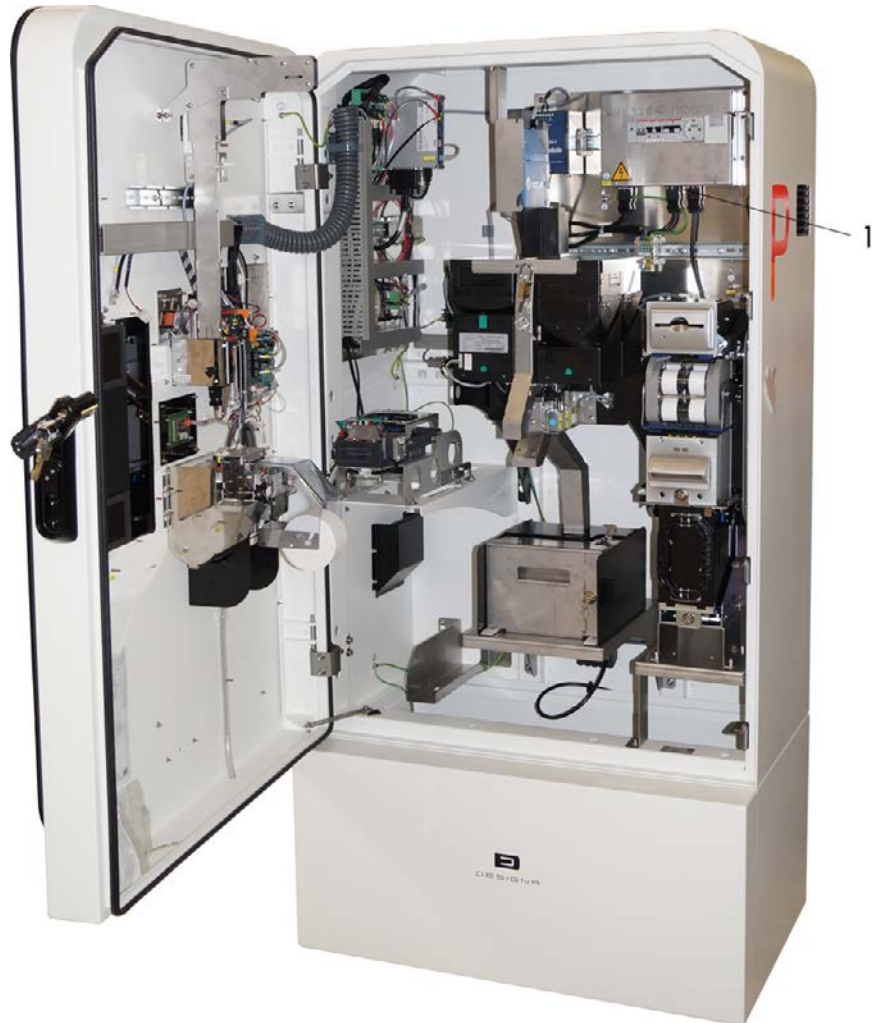
Fig. 39 : Point de mesure pour le contrôle de l'impédance des boucles d'erreur
