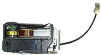
Fig. 51 : Imprimante à aiguilles
