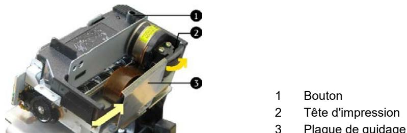
Fig. 59: Mettre en place la cassette de ruban encreur
