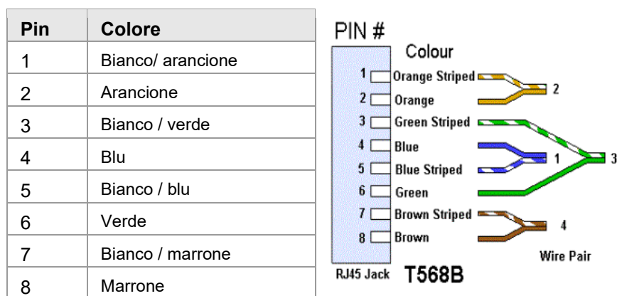
Fig. 36: Assegnazione secondo lo standard EIA/TIA-T568B
