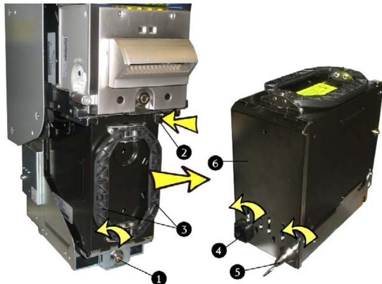
Fig. 87: Prelievo e apertura della cassetta terminale
