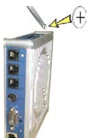
Fig. 43: Sostituzione delle batterie sull'LCC
