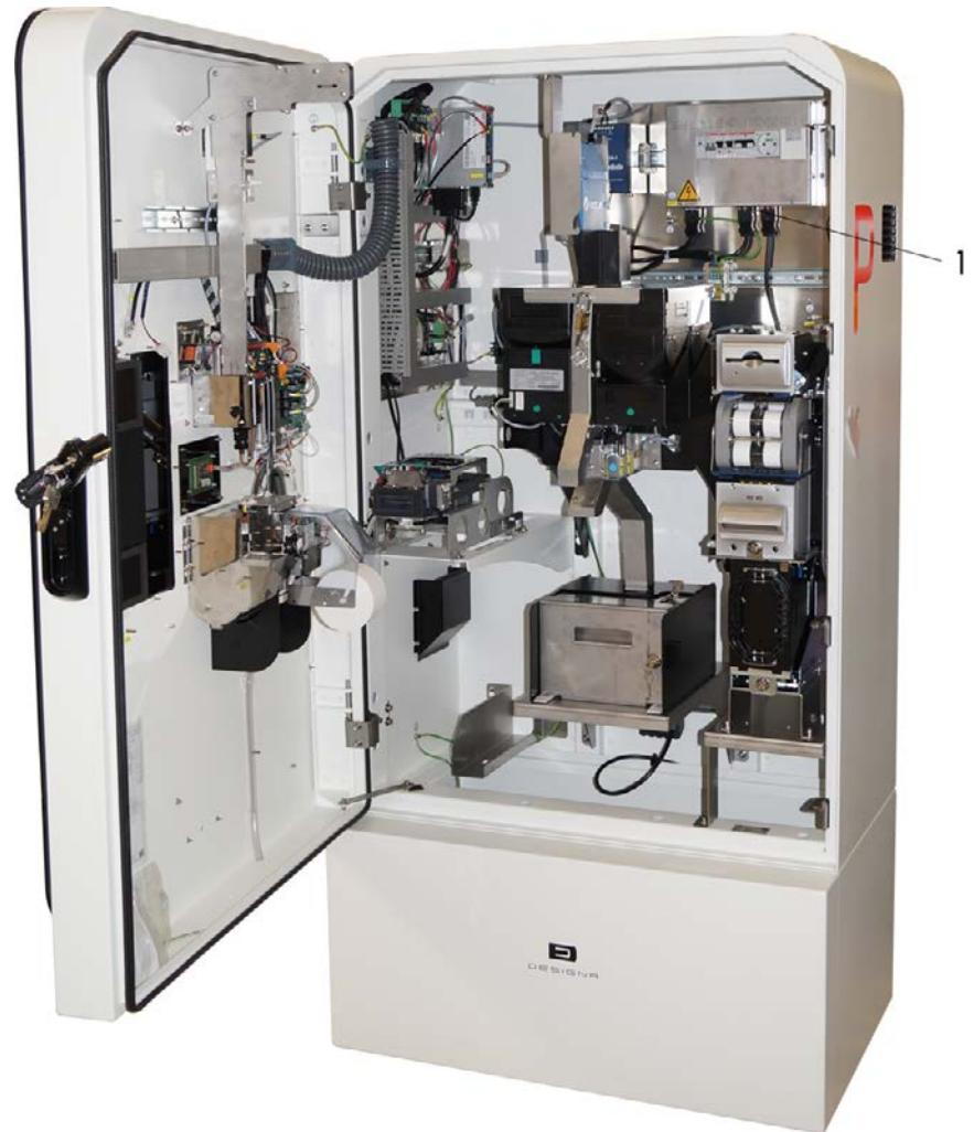
Fig. 39: Punto di misurazione per la verifica dell'impedenza dell'anello di guasto
