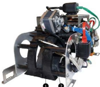
Fig. 62: Doppia unità di alimentazione (opzione)
