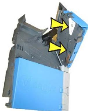
Fig. 79: Pulizia del bordo inferiore del canale delle monete
