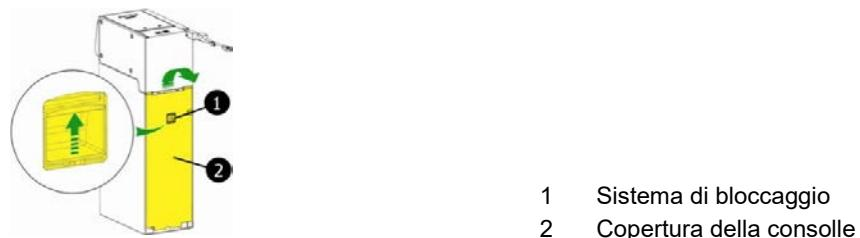
Fig. 110: Apertura della copertura della consolle
