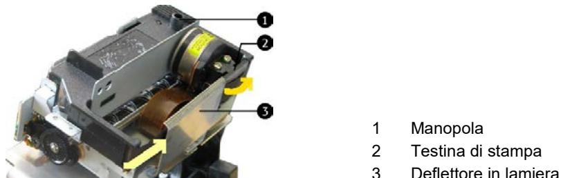
Fig. 59: Inserimento della cassetta nastro inchiostrato
