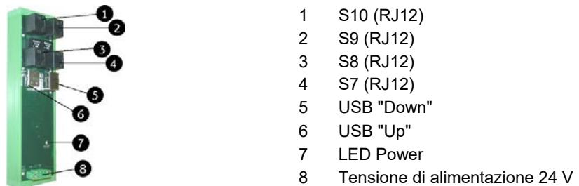
Fig. 42: Espansione interfacce seriali USB-4-COM
