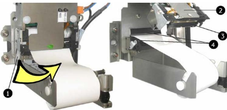
Fig. 74: Rilascio della leva di apertura e sgancio dell'unità di stampa dal rotolo di carta
