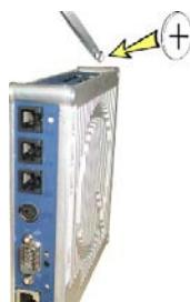
Abb. 42: Batteriewechsel am LCC
