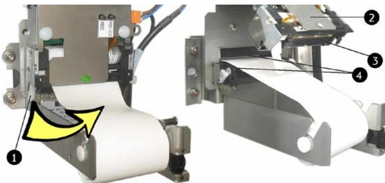
Abb. 73: Öffnungshebel lösen und Druckereinheit von der Papierrolle lösen
