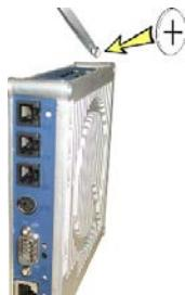
Fig. 42: Cambiar la batería del LCC
