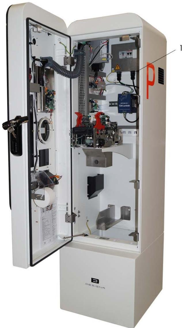
Fig. 38: Punto de medición para la revisión de la impedancia del bucle de falla
