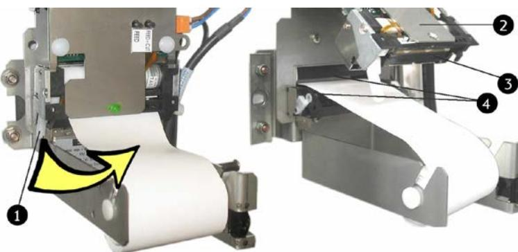
Fig. 73: Libere la palanca de apertura y libere la *unidad de impresión* del rollo de papel
