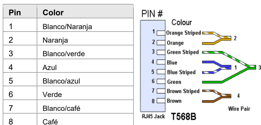
Fig. 35: Configuración conexión Ethernet, EIA/TIA-T568B
