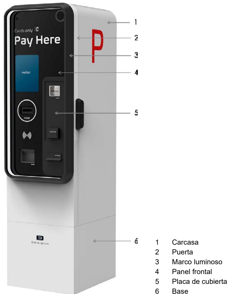
Fig. 6: Construcción general (figura con opciones)
