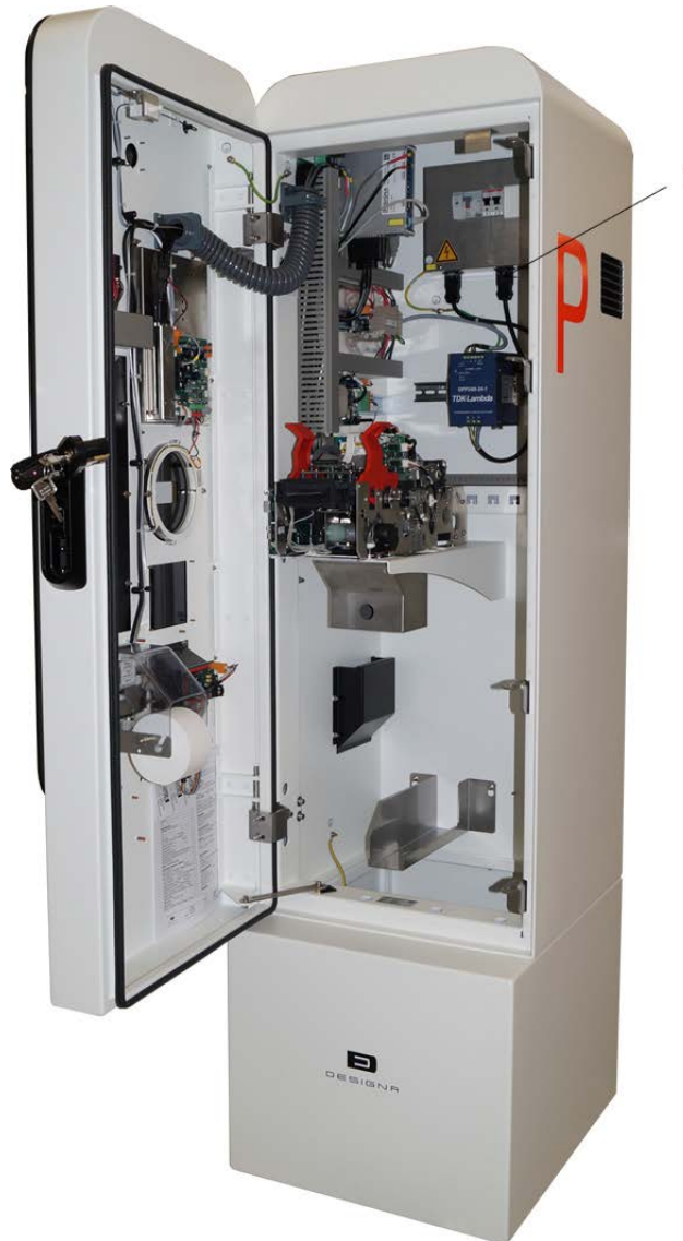
Fig. 38 : Point de mesure pour le contrôle de l'impédance des boucles d'erreur
