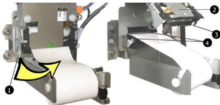
Fig. 73: Rilascio della leva di apertura e sgancio dell'unità di stampa dal rotolo di carta
