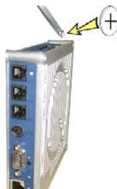
Fig. 42: Sostituzione delle batterie sull'LCC
