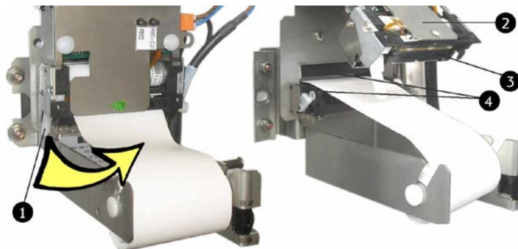
Fig. 74: Rilascio della leva di apertura e sgancio dell'unità di stampa dal rotolo di carta
