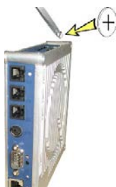
Fig. 43: Sostituzione delle batterie sull'LCC
