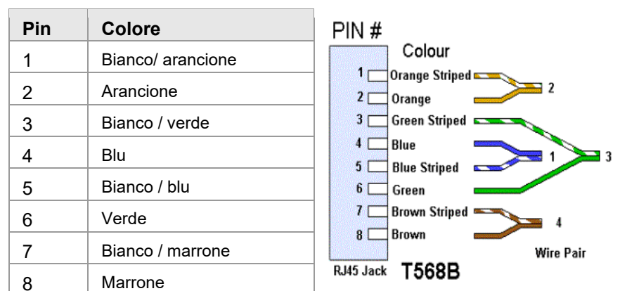
Fig. 35: Assegnazione secondo lo standard EIA/TIA-T568B
