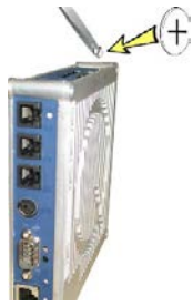
Abb. 44: Batteriewechsel am LCC
