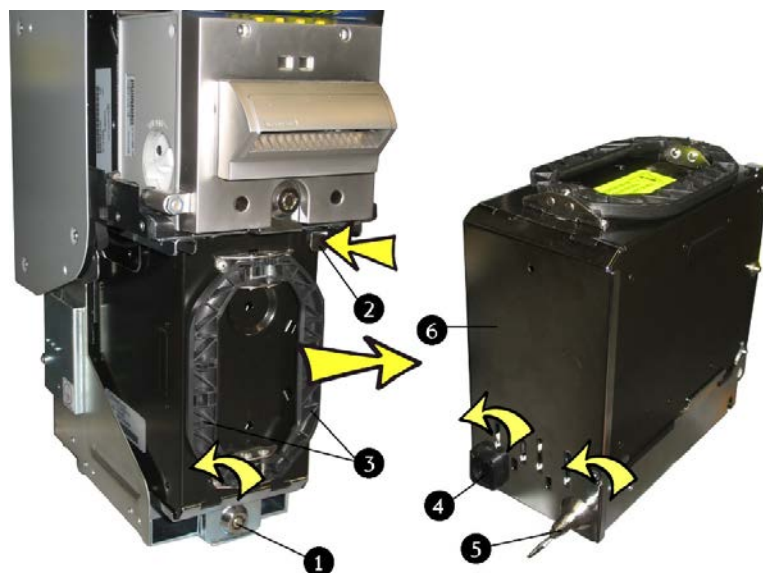
Abb. 77: Endkassette entnehmen und öffnen
