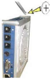
Abb. 43: Batteriewechsel am LCC
