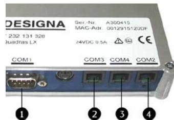
Drei serielle Schnittstellen RJ12 und eine serielle Schnittstelle 9pol. D-Sub stehen zur Verfügung.
