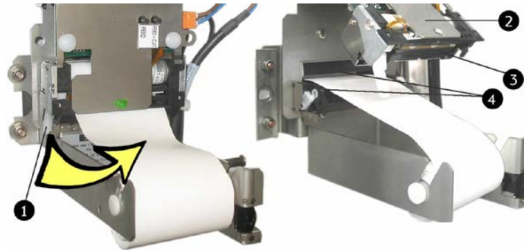
Abb. 30: Öffnungshebel lösen und Druckereinheit von der Papierrolle lösen
