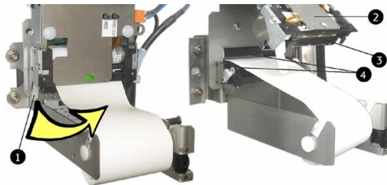
Abb. 33: Öffnungshebel lösen und Druckereinheit von der Papierrolle lösen
