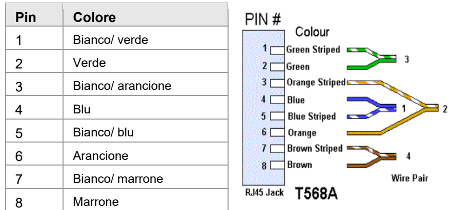
Fig. 22: Assegnazione presa Ethernet, EIA/TIA-T568A
