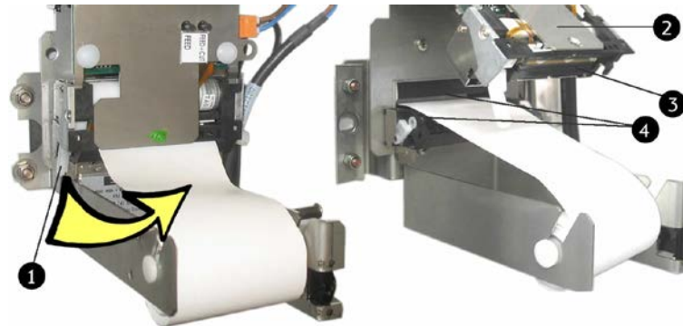
Abb. 34: Öffnungshebel lösen und Druckereinheit von der Papierrolle lösen
