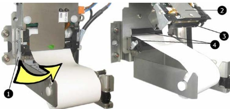
Fig. 48: Libere la palanca de apertura y libere la *unidad de impresión* del rollo de papel
