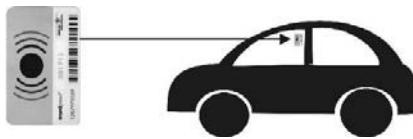
Detrás de la lámina protectora **no funciona** el transpondedor.
