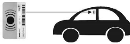
Hinter der Metallbedampfung ist **keine** Funktion des Transponders gegeben.
