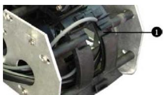
Abb. 46: Zuführspalt MPS
