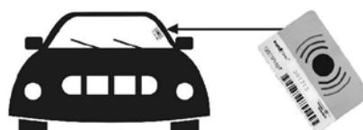
Der Transponder funktioniert direkt hinter den Heizdrähten, allerdings ist die Reichweite eingeschränkt.
