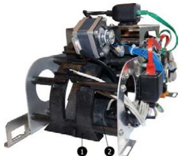
Abb. 59: Doppelte Zuführeinheit (Option)
