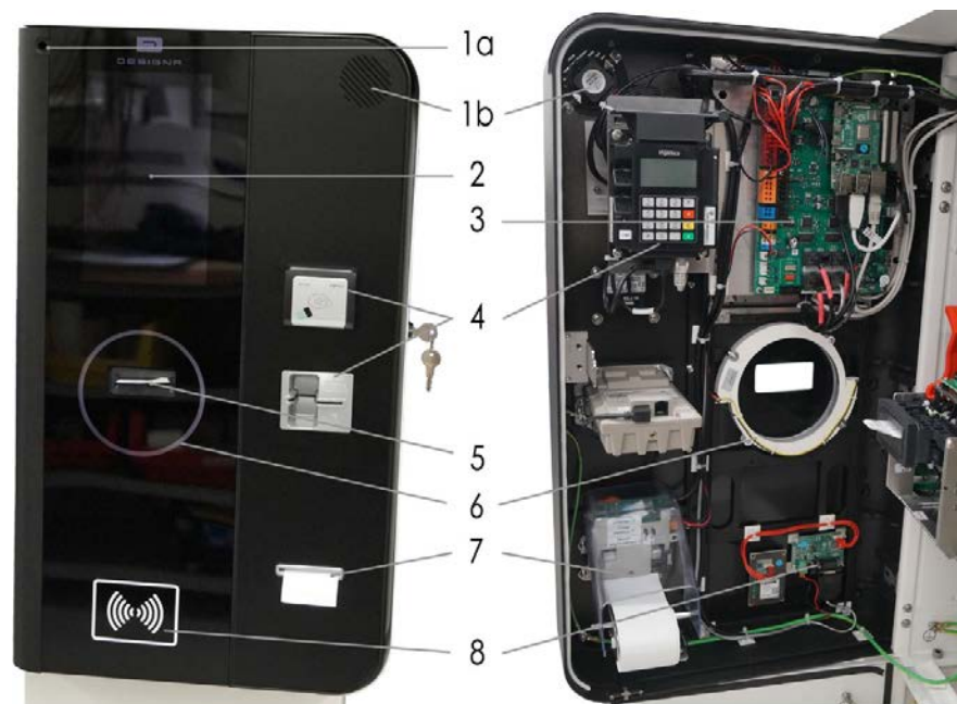
Abb. 9: Bedienelemente an der Gehäusetür (Abbildung mit Optionen)
