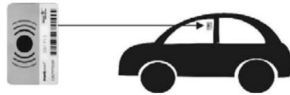
Abb. 83: Windschutzscheibe mit vollflächiger Metallbedampfung
