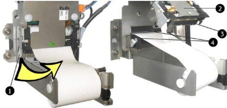
Fig. 76: Libere la palanca de apertura y libere la unidad de impresión del rollo de papel
