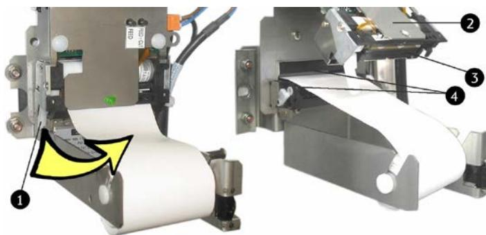
Fig. 71 : Desserrer le levier d'ouverture et écarter l'unité d'impression du rouleau de papier
