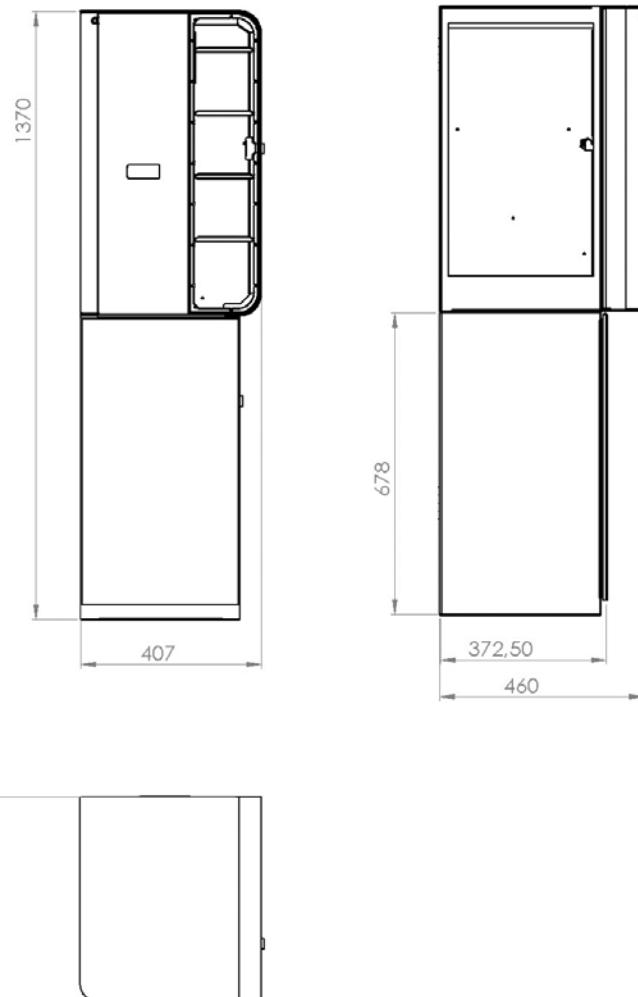
Fig. 4 : IN/OUT, dimensions en mm
