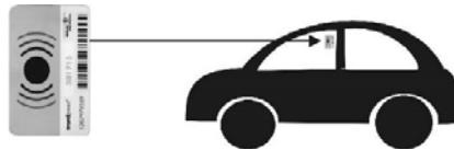
Derrière la métallisation, le transpondeur ne fonctionne **pas**.
