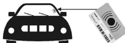
Le transpondeur fonctionne derrière les filaments de chauffage, mais sa portée est limitée.
