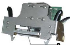
Fig. 49 : Imprimante thermique
