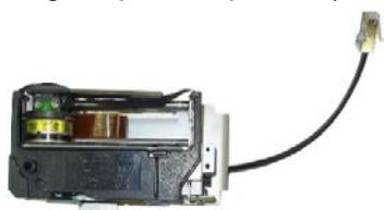
Fig. 48 : Imprimante à aiguilles
